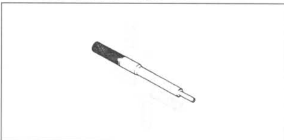
Valve Guide Arbor, \Phi 4.5 : 57001-1331
